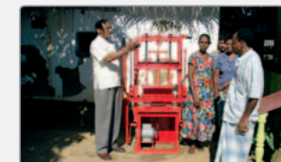
Sam Rajasuriar führt einer Gruppe von Kaffirs die Funktion der sog. „Earthblock Making Machine“ vor, damit sie die Backsteine selbst herstellen können.
